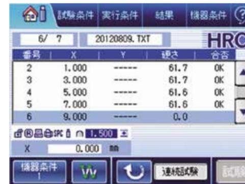
配备指导设置试验位置的导航功能。可通过简单操作进行多点试验的顶端淬透性试验专用画面。
