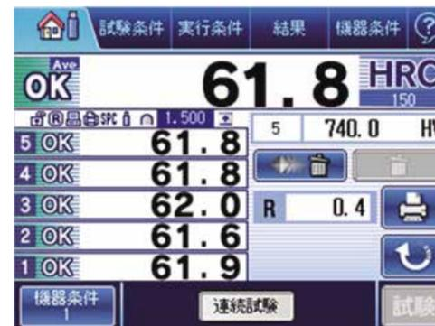
放大显示任意指定的多个部位的平均硬度。适用于计算多个试验部位的平均硬度。
