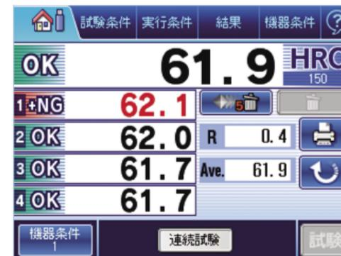
以列表形式显示试验结果的记录。适用于确认试验结果的前后关系、偏差及平均值。
