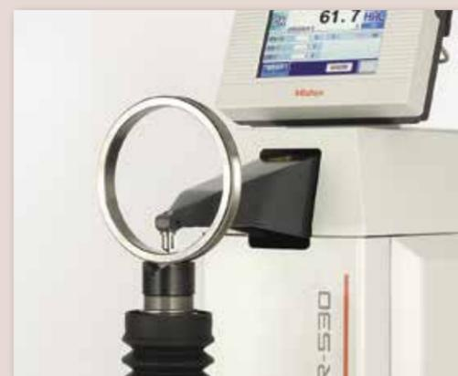
可进行以往只有切断才能试验的内壁硬度试验。(所有机型)
