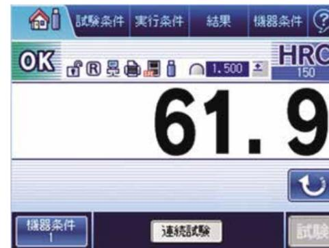
只显示试验结果和刻度，适合相同条件下的重复试验。
