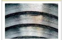
加工材SUS304,在使用水溶性切 削油的加工環境中,也能獲得精良 的内螺紋表面。
