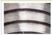
加工材SUS304,在使用水溶性切 削油的加工環境中,也能獲得精良 的内螺紋表面。
