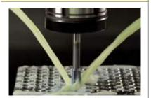
特殊構型設計和絲攻有較長伸出長 度,可充分供給切削油,最適合水 溶性切削油加工。
