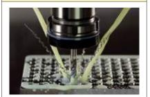
特殊構型設計和絲攻全長有較長 的伸出長度,可避免切屑排出的 干涉,最適合水溶性切削油加工。
